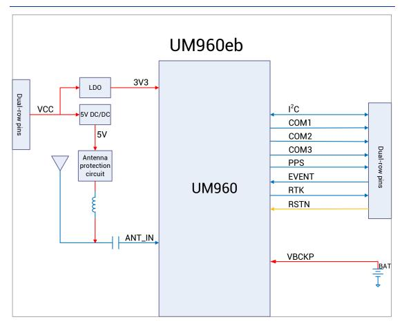
Figure 1-1 UM960eb Block Diagram<sup>1</sup>
